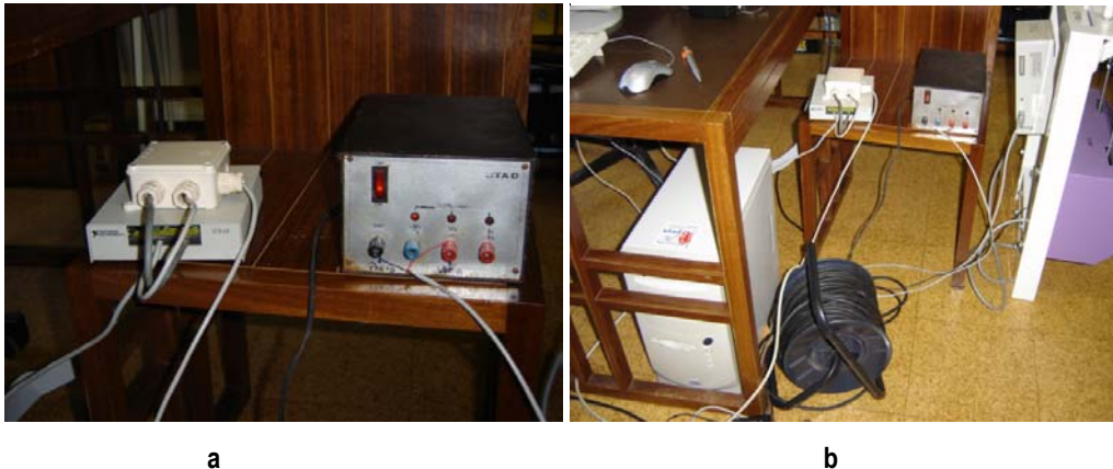
Figura 23. Placa de conversão analógico digital (esquerda, em baixo), caixa de derivação (esquerda em cima) e fonte de alimentação (direita) [a] e forma de conexão com o computador e com a swim bench [b].
