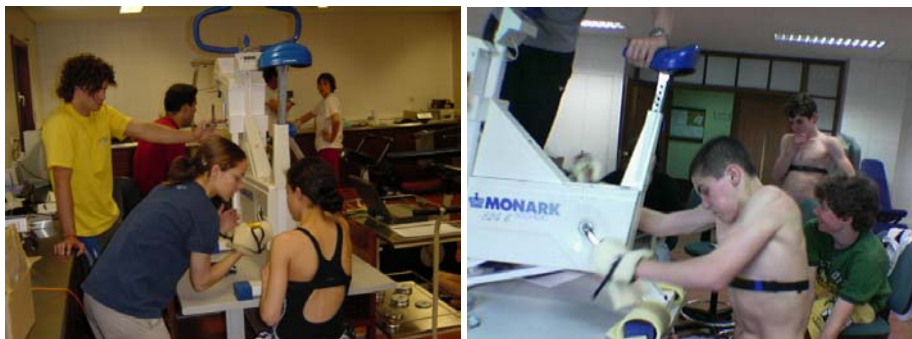
Figura 26. Adaptação do cicloergómetro para a realização de medidas de potência dos membros superiores.
